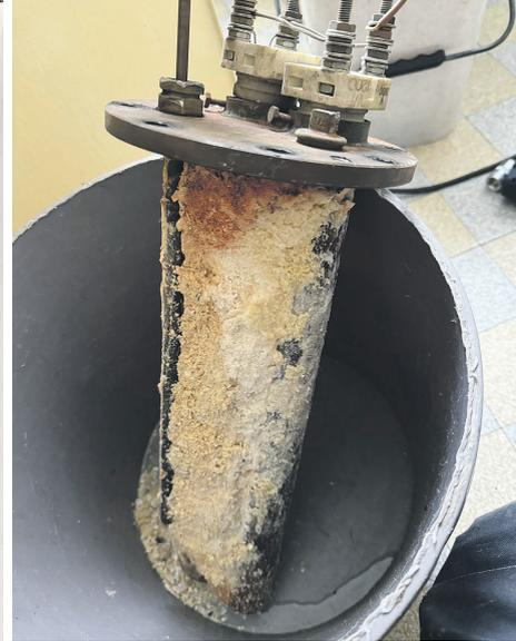
Durch Ablagerungen nimmt die Heizleistung des Wassererwärmers ab, deshalb sind regelmässige Entkalkungen notwendig.
